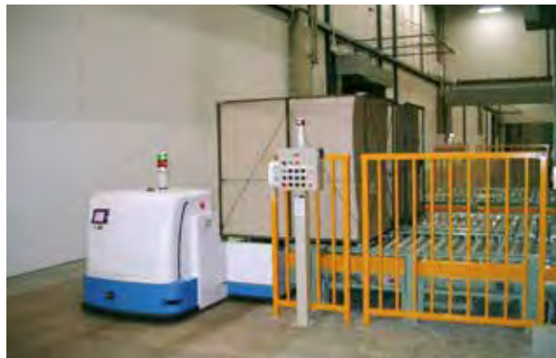
●出货作业中AGV向滚筒台上移送货物。
