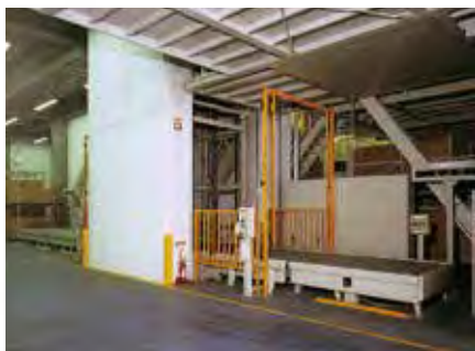
● 垂直输送机装货区
