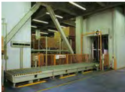
● 垂直输送机取货区
