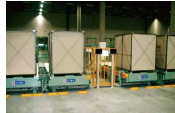
●中转滚筒输送台 (搬送物1,000kg/个)
