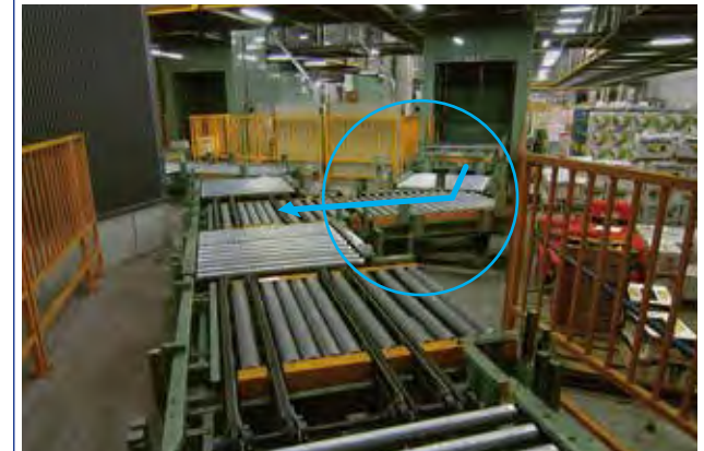
●图中远处的2台垂直输送机搬送来的货物，通过方向转向滚筒组，将货物合流至一条滚筒输送线上。(○圈中的滚筒组旋转将货物搬送到滚筒输送线上。)
