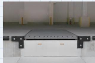
●普段は床面と同一の高さを保ち、倉庫内の往来に支障なく対応します。必要に応じて、地上とプラットホームとの段差をゆるやかなスロープで解消することができます。(傾斜角度7.0°、先端部スライド幅1,000mm)
