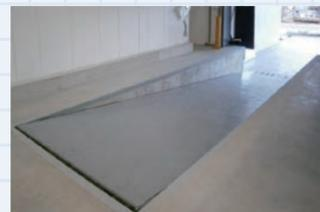
●安定したスロープをつくります。クライミングレベラーの先端部には、上昇時500mm、下降時1,000mmのスライドクリップがありますので、フォークリフトの乗り移りに段差を感じさせない安定感があります。
