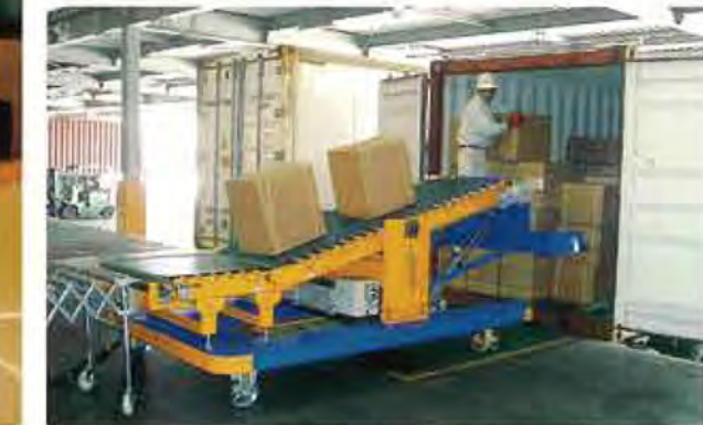
●エクステナー II 型を活用したデバンニング作業 (先端部高位置)
