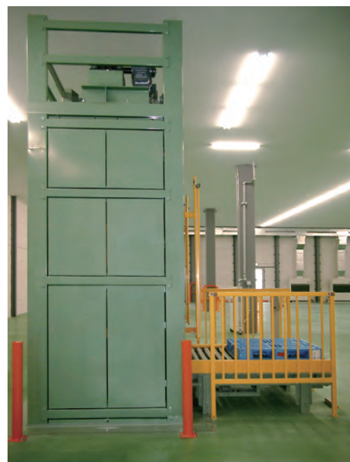
●タワーパネル付き自立式タワー
