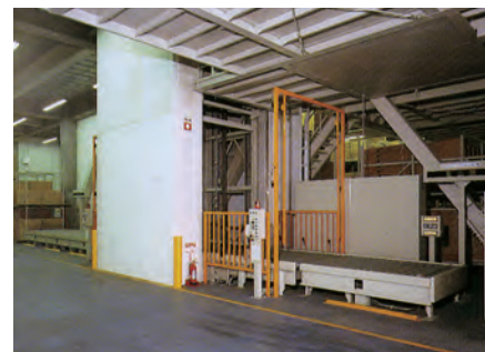
●オムニリフター積込側
